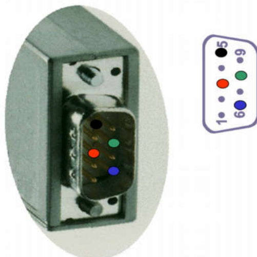
شکل ۱۹-۵- کانکتور ۹ پین نوع D (همان کانکتور ۹ پین سریال)
