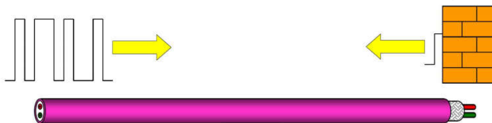
شکل ۶-۱۴- بازتاب سیگنال در کابل
