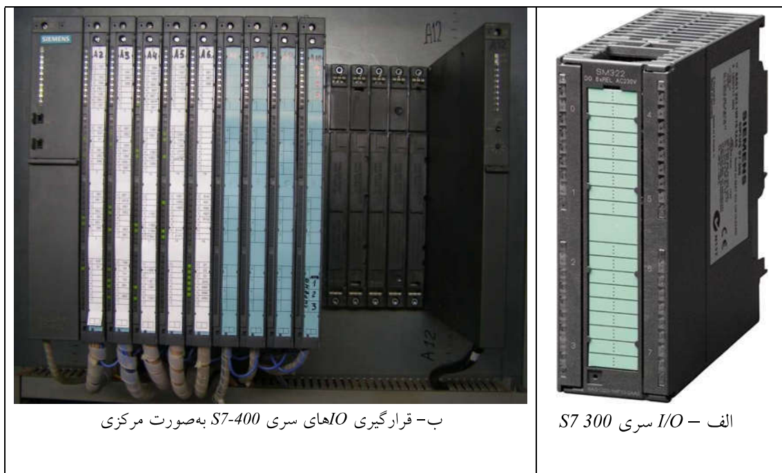
شکل ۸-۱- نمایشی از ماژول های I/O سامانه PCS7
